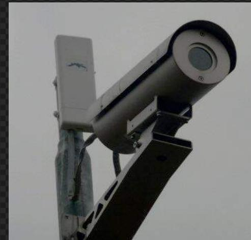
Le termocamere possono essere alimentate da pannelli fotovoltaici, ed essere dotate di trasmettitore Wireless, per trasmissione immagini termiche alla sala controllo.
