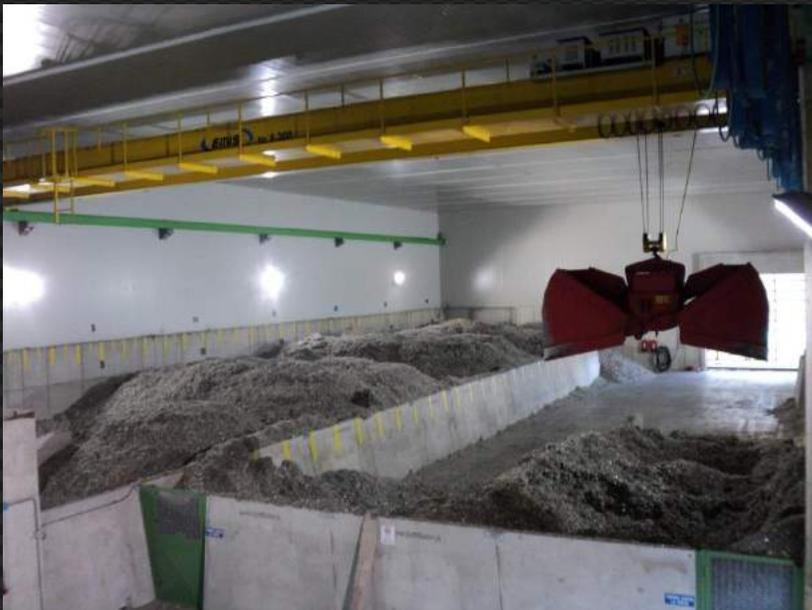
I depositi di CDR (Combustibile Derivato dai Rifiuti) possono essere soggetti ad incendio per problemi di autocombustione, per cui è necessario avere un sistema di monitoraggio temperature che permette di ottenere un allarme anticipato.
