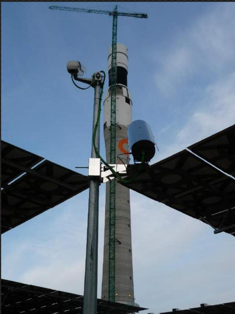
Le 4 termocamere con teleobiettivo da 6° puntano da 4 posizioni diverse sulla caldaia solare per il monitoraggio della temperatura del fascio tubiero. Dette temperature permettono di ottimizzare la posizione degli specchi per ottenere le desiderate temperature sul fascio tubiero ed ottenere il miglior rendimento.
